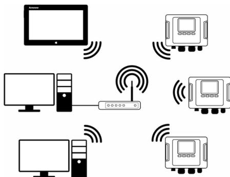
I dispositivi PQM-710 e PQM-711 hanno tutti i vantaggi degli analizzatori PQM-702 e PQM-703: il **ricevitore GPS** integrato che garantisce un'elevata precisione dell'orario e il **modem GSM** che facilita l'esecuzione delle misure da remoto. Similmente al PQM-703, anche il PQM-711 è munito di un **registratore di transienti** (frequenza di campionamento 10MHz, portata delle tensioni **fino a  $\pm 8000$  V**).
